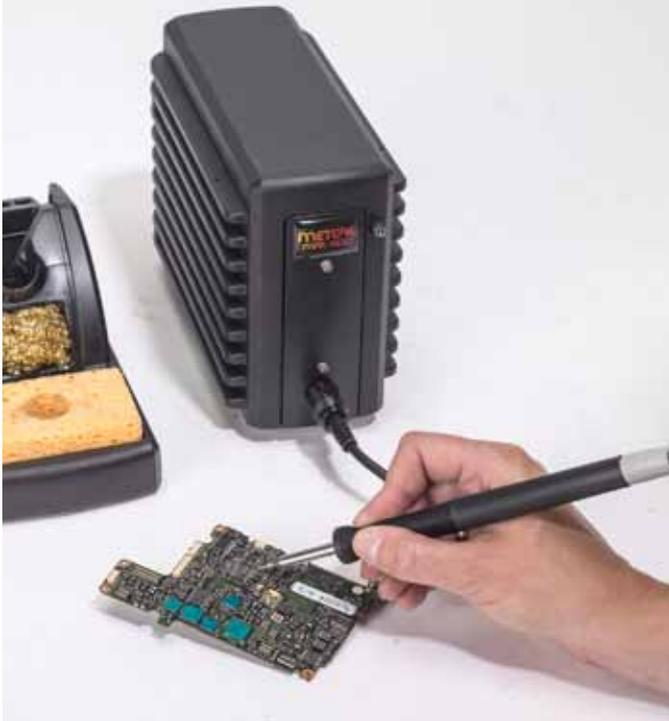
Das System MFR-1100 hat einen Ausgangskanal und eignet sich mit seiner hohen Leistung gleichermaßen für Produktionslöten, Nacharbeit und SMD-Rework.
